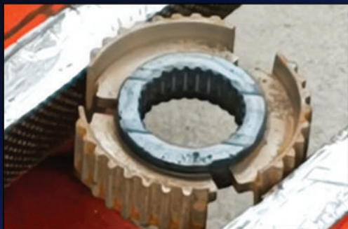
قبل از تمیزکاری با آیس بلاست
