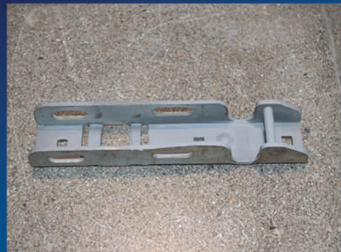
بعد از تمیزکاری با آیس بلاست
