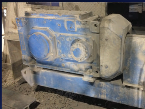
قبل از تمیزکاری با آیس بلاست
