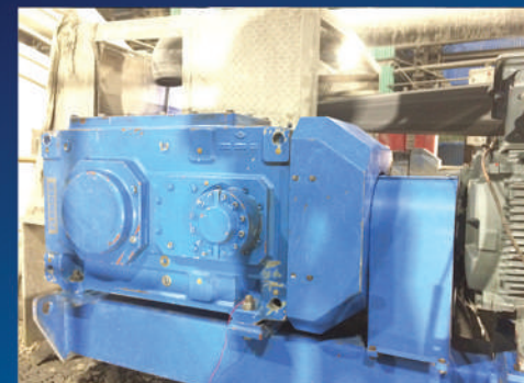
بعد از تمیزکاری با آیس بلاست
