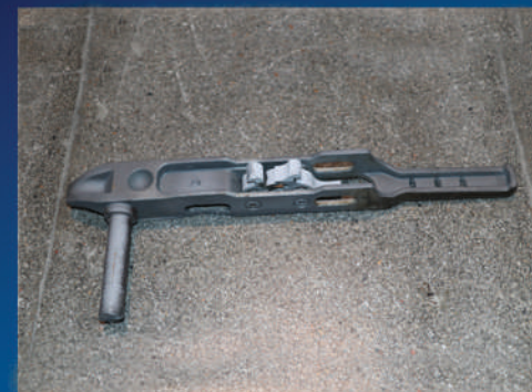
بعد از تمیزکاری با آیس بلاست
