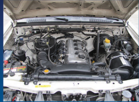
بعد از تمیزکاری با آیس بلاست
